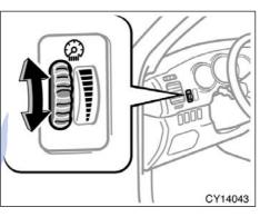
To adjust the brightness of the instrument panel lights, turn the dial. تلفن شبانه روزی: ۵۸ + ۲۹۸۷
