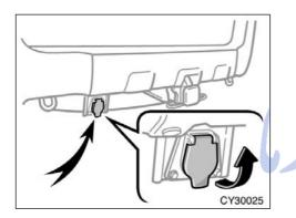
TOWING CONNECTOR FOR TRAILER LIGHTS
